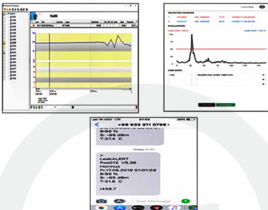
تصویر شماره (۱۱): نحوه عملکرد دستگاه نشت یاب آنلاین در زمان کشف نشت و اعلام به صورت پیامک به بهره‌بردار
