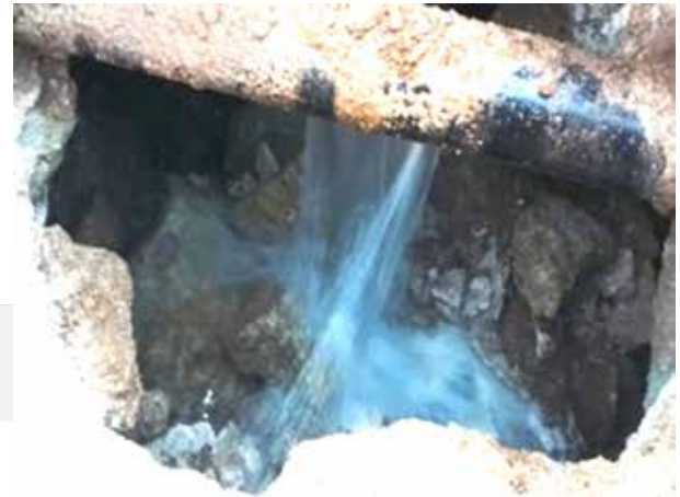
تصویر شماره (۸): نمونه‌ای از کشف نشت در شبکه و انشعابات آب
